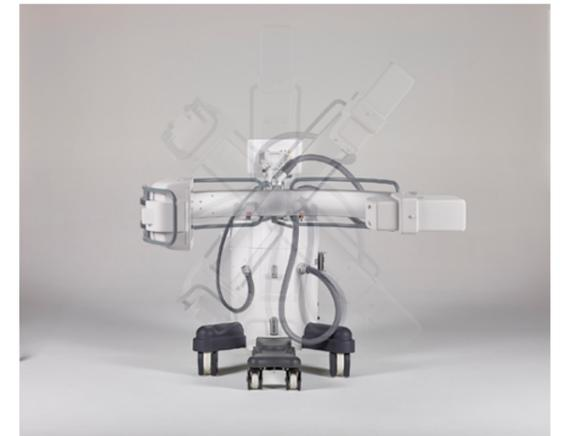
La hauteur variable motorisée du bras en C et l'ensemble des autres mouvements manuels de l'arceau, ainsi que les poignées de préhension de chaque côté du C, assurent le positionnement du système. Chaque levier de déblocage est repéré par un code couleur correspondant à un mouvement.
